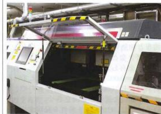
図3 最新の三菱電機製CO 2 レーザー（2ヘッド式）
