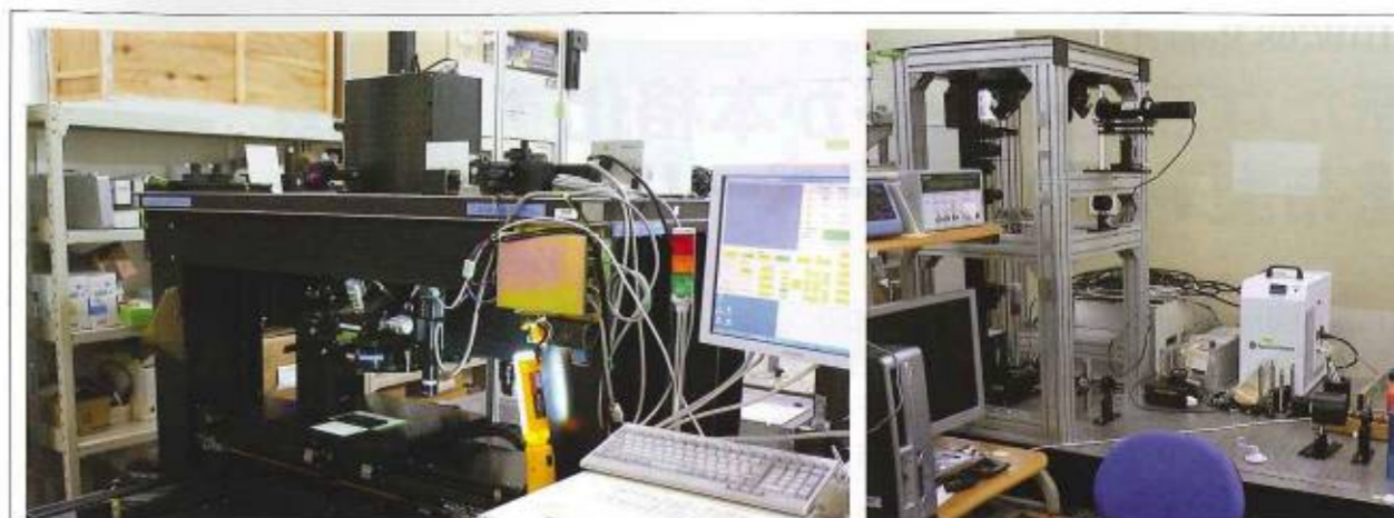
図1 自社開発したピコ秒レーザー搭載の加工生産性実証装置
